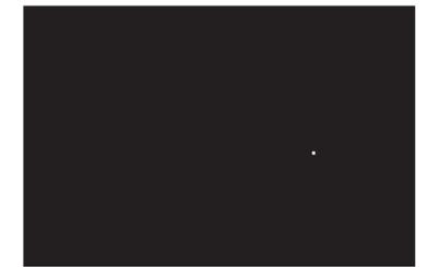
使用する映像素子（CCD センサー）はまれに輝点（画素ドット抜け）を起し、暗いシーンなどで画素ドットが目立つ場合があります。
